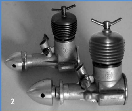
Selbstzündler-Motoren 1 ccm + 2,5 ccm von Benno Schlosser 1957
