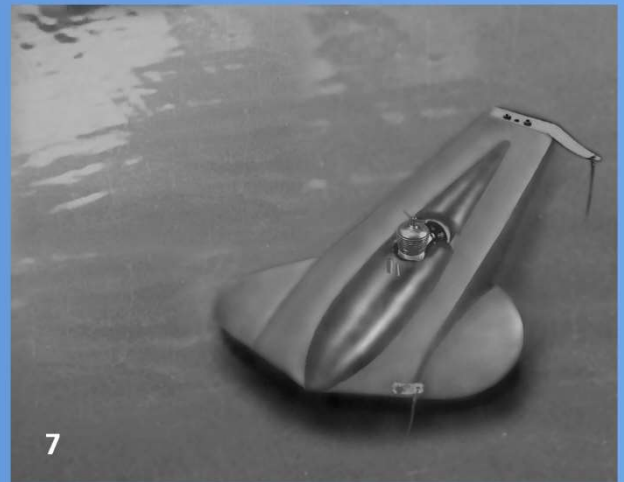
Modellrennboot Klasse A2 mit Schlosler 2,5 ccm Konstruktion Werner Papsdorf 1958 (2. Version)
