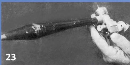
**Rennmotor K & B 15 (USA) mit Flachdrehchieber u. Resonanzauspuff, 1969**
