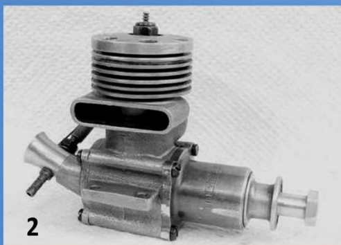
2 Glühzünder VLTAVAN 5 cm 3 (ČSSR, 1960) mit Graugussbuchse, Aluminium-Nasenkolben mit zwei Kolbenringen und Flachdrehchieber aus Kunststoff
