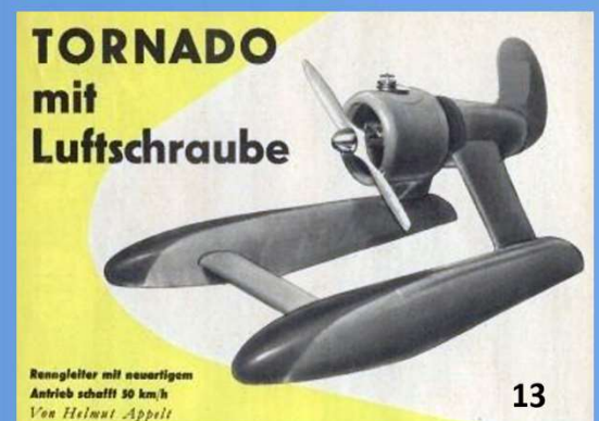
Rennboot mit Luftschraubenantrieb für 2,5 - 3,5 ccm-Motoren von H. Appelt (Technik-Magazin hobby 1956)
