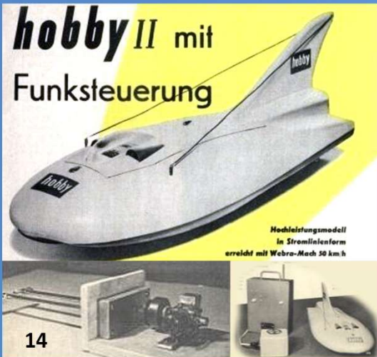
Ferngesteuerter Stufengleiter von H.-P. Hirzel mit Webra-Diesel und Getriebe mit zwei Antriebswellen (Technik-Magazin hobby 1955)
