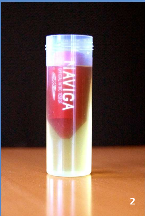
NAVIGA Nitro-Tester in hochprozentigem Nitromethan (ca. 90 % Vol.-%)
