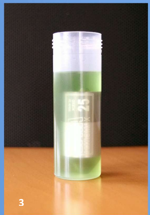
Prüfkörper NITROMAX 25 in regelkonformem Gemisch mit 23 % Nitro (MAXIMA Tarmac 25 + 2 % Rizinusöl)
