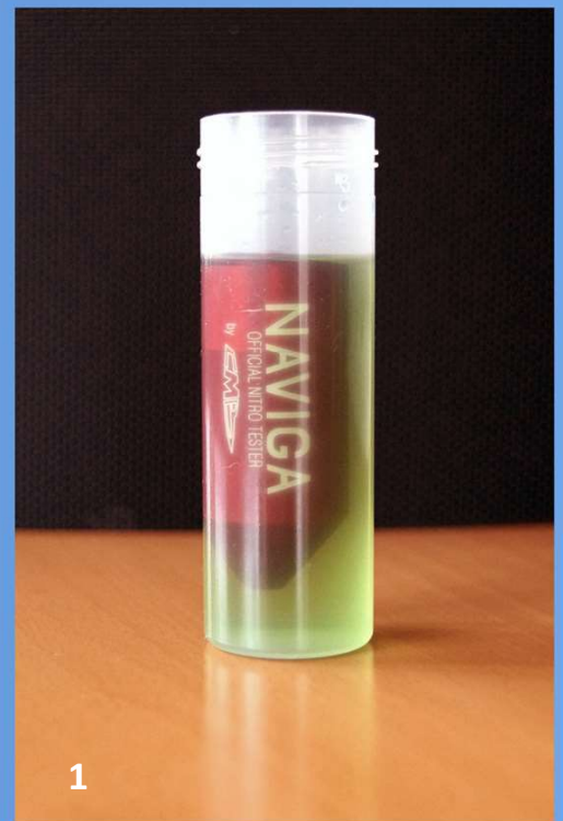
NAVIGA Nitro-Tester in regelkonformem Kraftstoffgemisch mit 23 % Nitromethan (MAXIMA Tarmac 25 + 2 % Rizinusöl)
